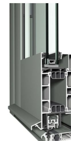
RÁM SE ŠÍŘKOU PROFILU 77mm (S PŘERUŠENÍM TEPELNÝCH MOSTŮ)
