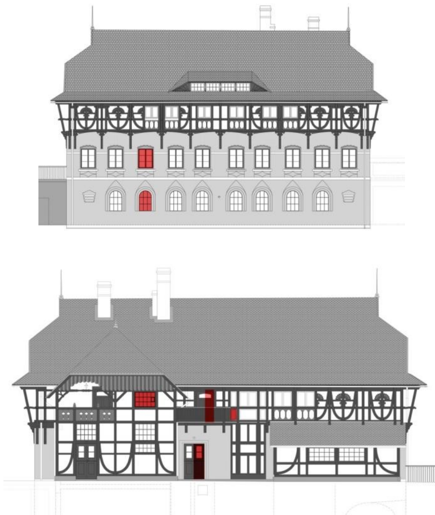
obr. SO-01 typy exteriérových oken, dveří určené k vzorkování
