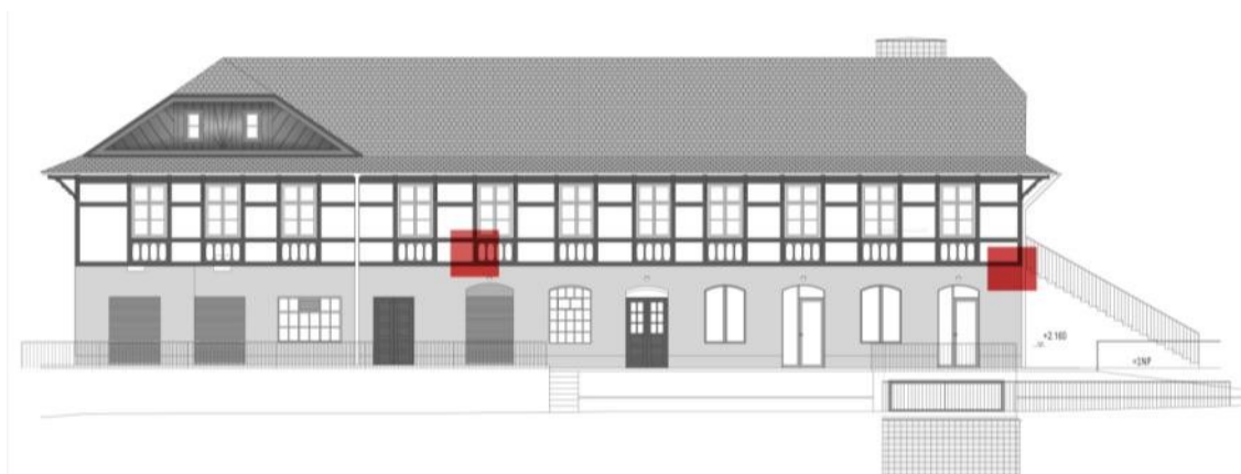
obr. SO-03 - předpokládané a ideální místo k vzorkování omítek
