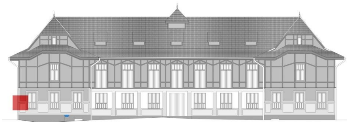
obr. SO-02 - předpokládané a ideální místo k vzorkování omítek
