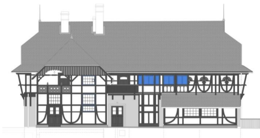
obr. SO-01 prvky a části exteriéru podléhající režimu restaurování
